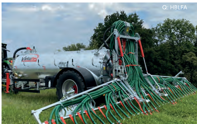
Abbildung 41: Eine bodennahe Ausbringung mit Schleppschuh kann bis zu € 100,- pro Hektar Stickstoffwert einsparen.
