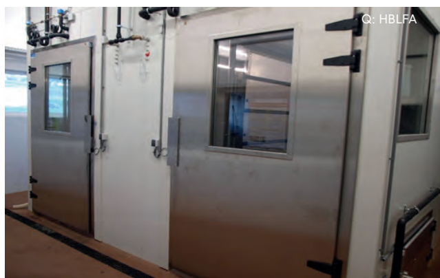
Abbildung 27: Respirationskammer zur Messung von CH 4 -Emissionen bei Rindern bei kontrolliertem Luftstrom an der HBLFA Raumberg-Gumpenstein.
