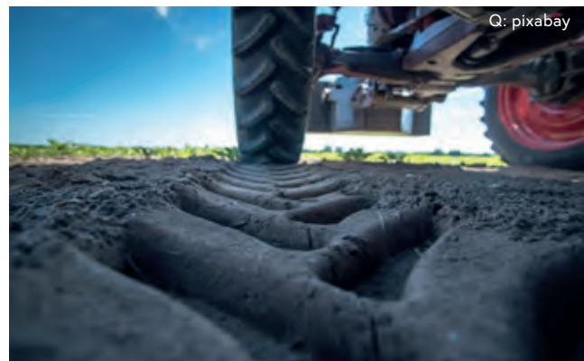
Abbildung 14: Optimale Reifendruckanpassung kann die Bodenverdichtung deutlich reduzieren und hilft N 2 O-Emissionen zu vermeiden.
