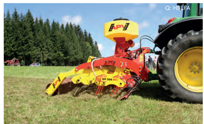
Abbildung 18: Arbeitsweise: Die Grasnarbe wird geöffnet, der Boden nur leicht angeritzt und die Samen breitflächig abgelegt.
