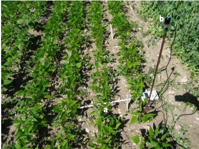
**Abbildung 7:** LAI Messung am 13. Juni 2017. Der Stab des Geräts (a) liegt unter den Bohnenpflanzen. Ein zweiter Sensor (b) misst die Sonneneinstrahlung.
