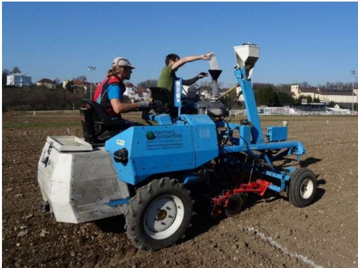
Abbildung 6: Aussaat mit der Parzellensämaschine am 18.03.17. Das Saatgut für eine Parzelle wird in den Verteiltrichter eingefüllt.
