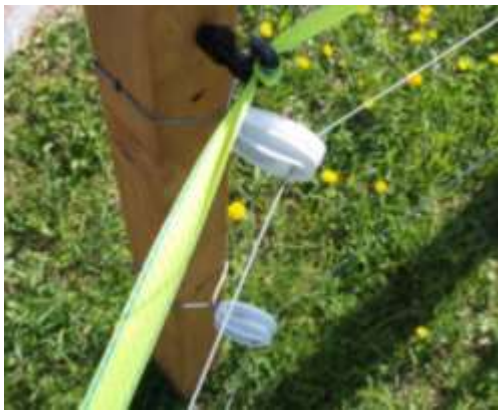
Strom springt über – abbrennen der Litzen
