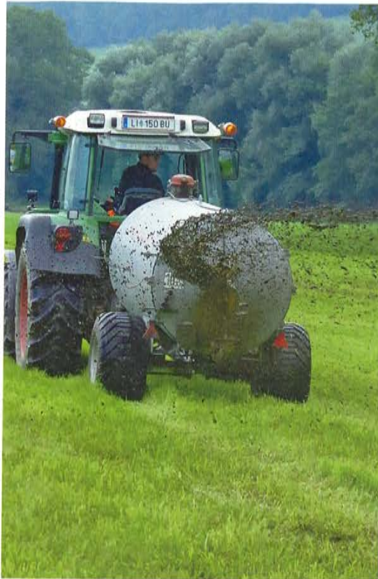
Schwenkverteiler, als Bauart der Prallteller, bilden große Tropfen und damit auch weniger N-Emissionen.
