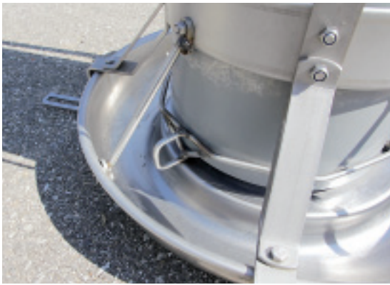
Der Boden der Futterschale ist gewölbt, in der Mitte hat sie eine Stufe.
