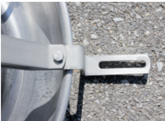
Der Automat wird mit vier Füßen am Spaltenboden befestigt.
