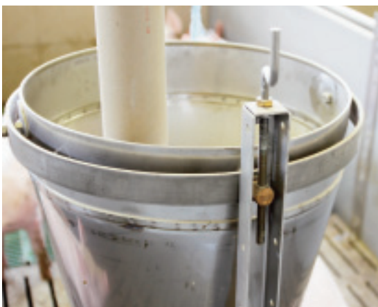
Mit dieser Kurbel kann man den Abstand zwischen Behälter und Futterschale verstellen.
