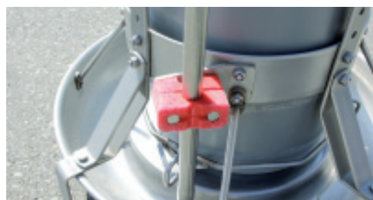
Ein Ferkel blieb zwischen der Rund-eisen-Verstreibung und dem Behälter stecken. Der Plastik-Backen wurde angeknabbert.
