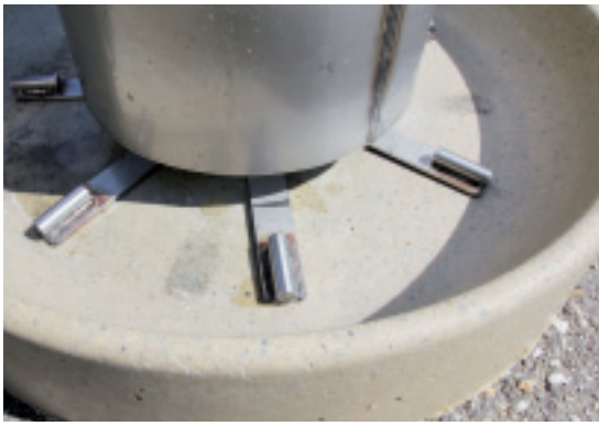
Die Flacheisen mit aufgeschweißten Rundeisen rühren das Futter aus dem Behälter in die Schale.
