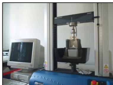
Fleischkerne (roh u. gegrillt) u. Scherkraftgerät für Zartheitsmessung
