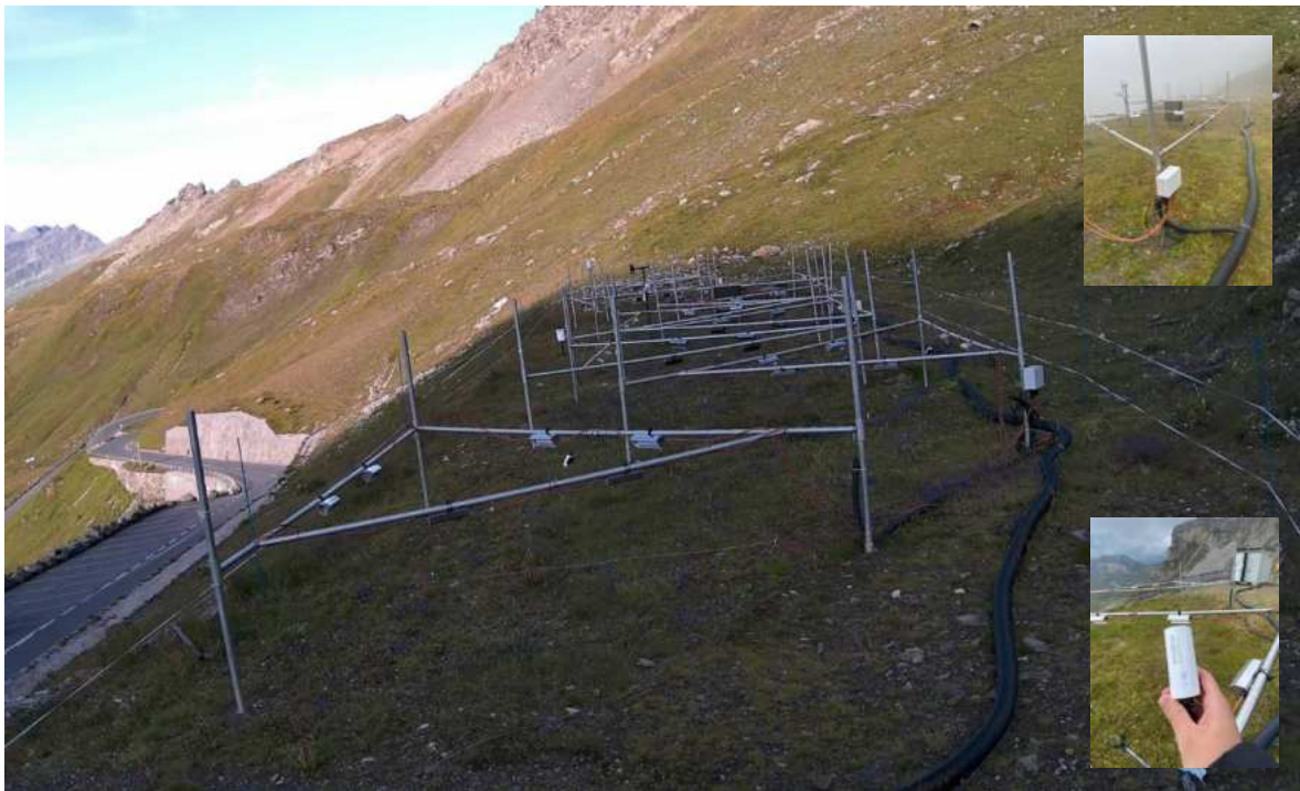
Abbildung 7 Trägergerüste für das Infrarot-Heizungssystem inkl. Verkabelung
