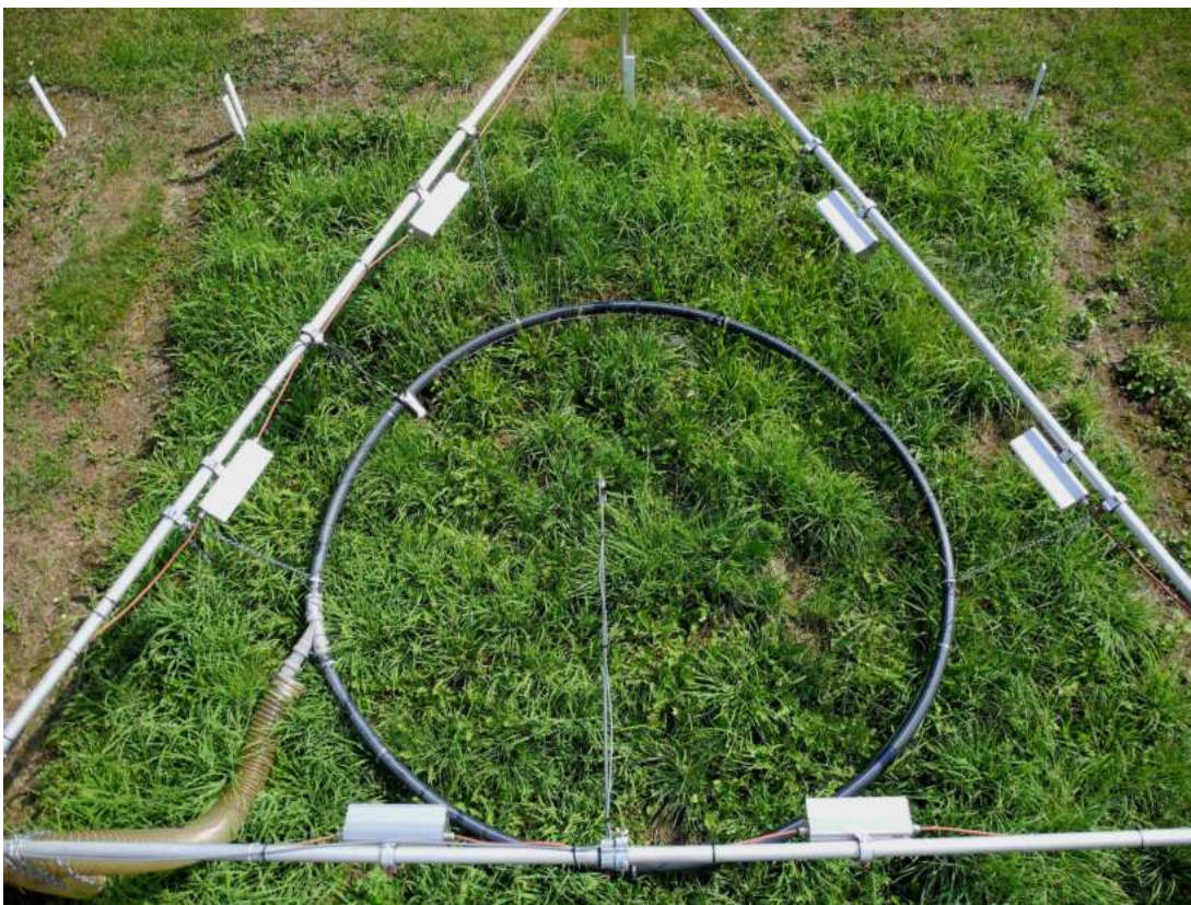
Abbildung 3 Infrarot-Heizungssystem im T-FACE Experiment an der HBLFA Raumberg-Gumpenstein
