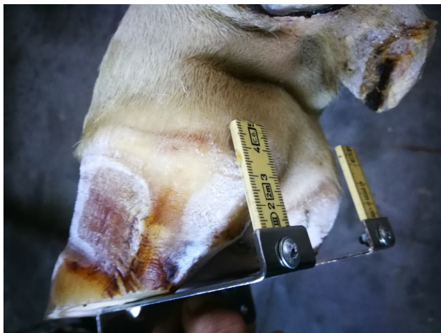
Abbildung 4: Messschablone zur Messung der Trachtenhöhe (PESENHOFER, R., 2020, Foto: EINGANG)
