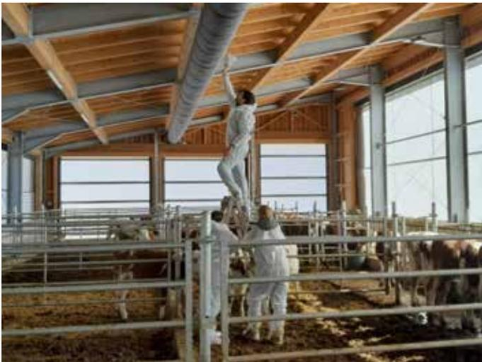
*Abbildung 23: Keimmessung im Bereich der Schlauchaustrittsöffnung*
