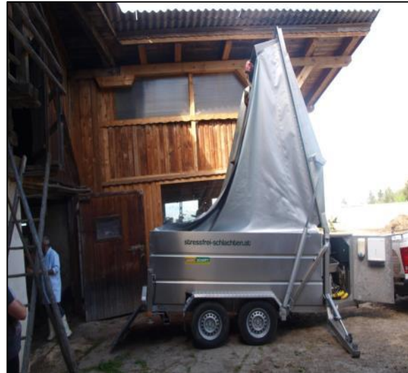
Foto 2: Mobiler Schlachtanhänger einsatzbereit (Foto: Kitzer)
