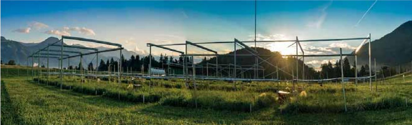
Abbildung 2: Feldversuch mit künstlich gesteuerter Erhöhung der Temperatur um +1,5 bzw. +3,0°C und Erhöhung der CO<sub>2</sub>-Konzentration um +150 bzw. +300 ppm an der HBLFA Raumberg-Gumpenstein
