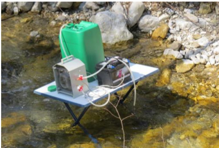
Abbildung 6: Die Einspeisung wurde mit einer Peristaltikpumpe durchgeführt (Weigelhofer G., 2015)
