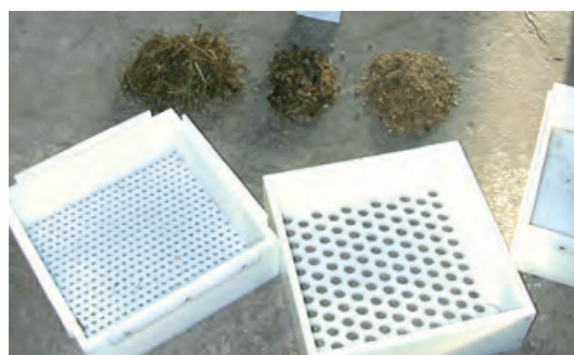
Um die Partikellänge feststellen zu können, sind eine Schüttelbox und eine Waage notwendig.
