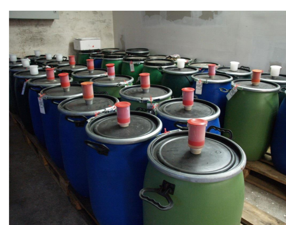
Abbildung 2: Lagerung Versuchssilos 60 Liter Weithalsfass mit Gärspund Raumtemperatur 24°C
