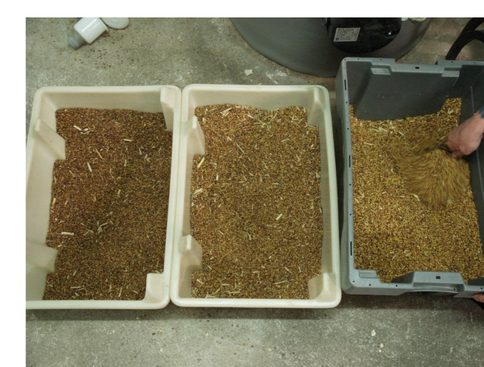
Abbildung 3: Beprobung Hirse-GKS Mischprobe aus oberem, mittleren und unteren Drittel des Silos.
