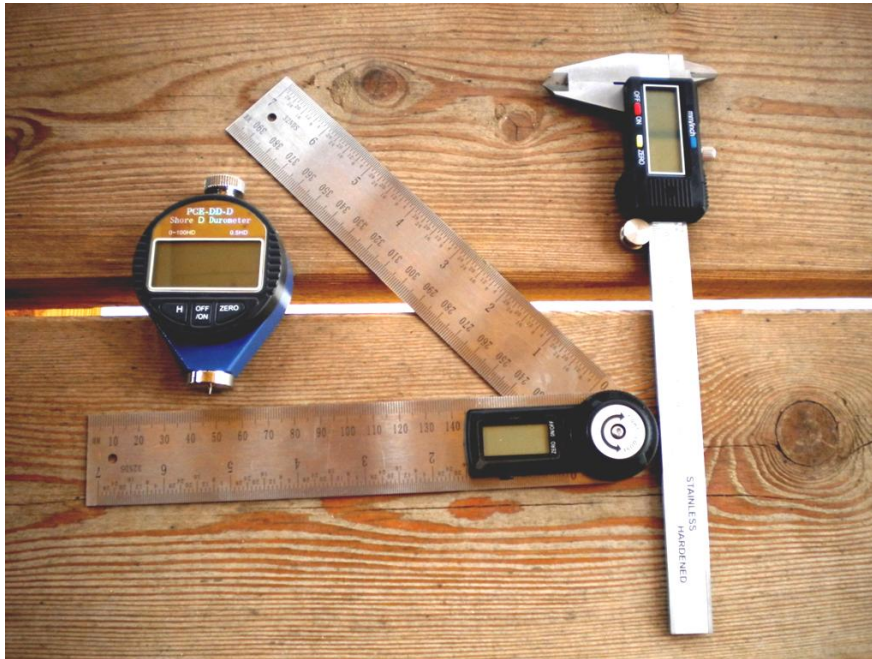
Abb. 9 Messinstrumente zur Erhebung der Klauenmaße (von re. nach li.: Schublehre, Winkelmesser, Härtemessgerät)
