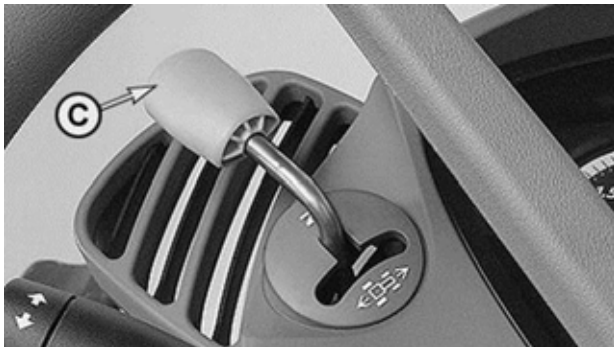
Abbildung 12: Wendeschaltung links vom Lenkrad JD AQ 6430 (JOHN DEERE PROSPEKT, 2010)
