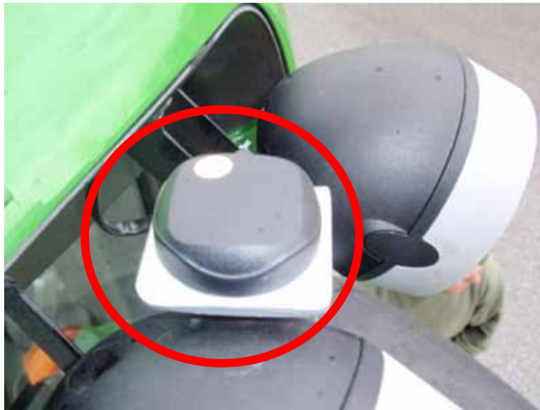
Abbildung 38: GPS-Empfänger am Kabinendach (EIGENFOTOGRAFIE)
