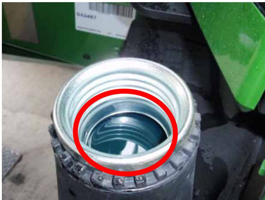
Abbildung 30: Tankfüllung bis zum unteren Rand des Tankdeckelgewindes (EIGENFOTOGRAFIE)
