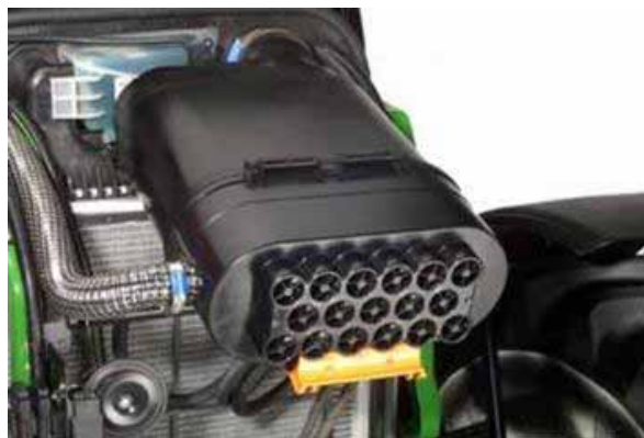
Abbildung 26: Power Core Luftfilter (JOHN DEERE ÖSTERREICH, 2010)
