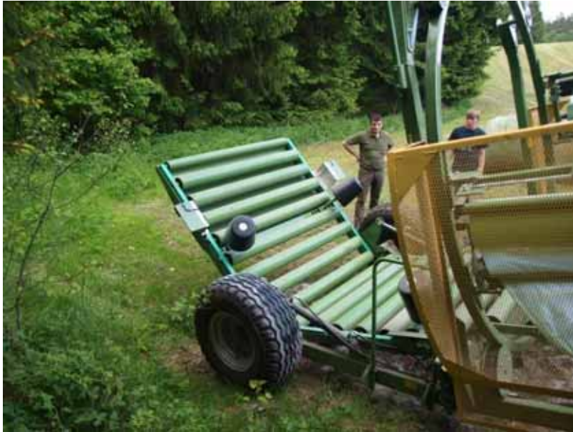
Bild 13: Hydraulisches Absenken der Gleitrollen
