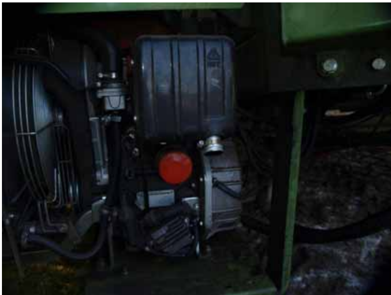
Bild 12: Dieselmotor mit Hydraulikpumpe
