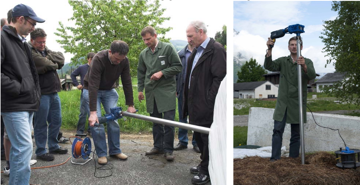
Abbildung 3: Silageprobenahme mittels Nirosta-Stechzylinder in Kombination mit einem maschinenbetriebenem Winkel-Untersetzungsgetriebe (nach H. Riegler)
