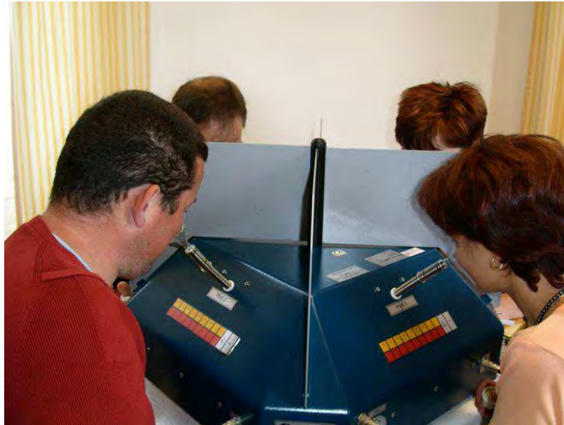
Abb. 12: Olfaktometer Mannebeck TO8: Gerät zur Messung von Geruchsemissionen (Quelle: Gumpenstein)
