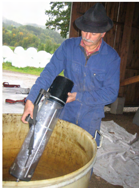
Abb. 16: Aufnahme der Geruchsproben mithilfe eines Unterdrucksaugers
