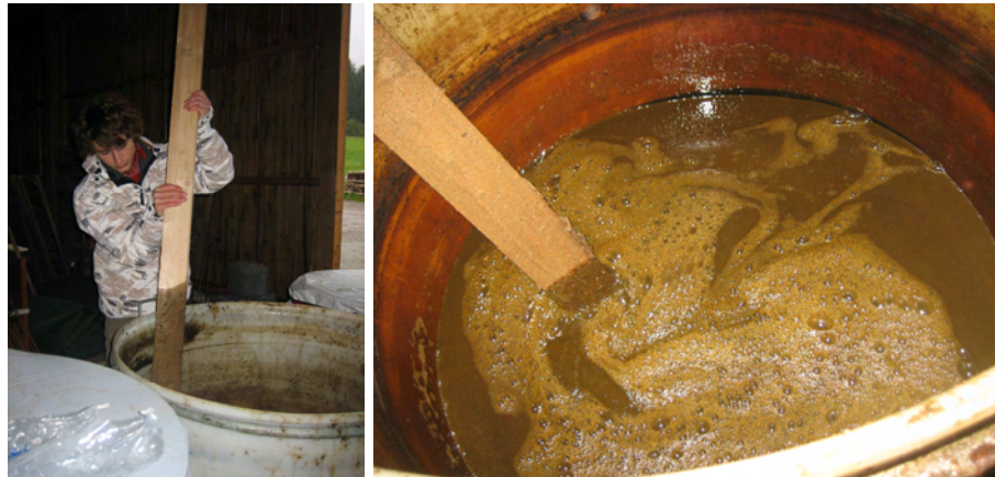
Abb. 15: Homogenisierung der Probegülle
