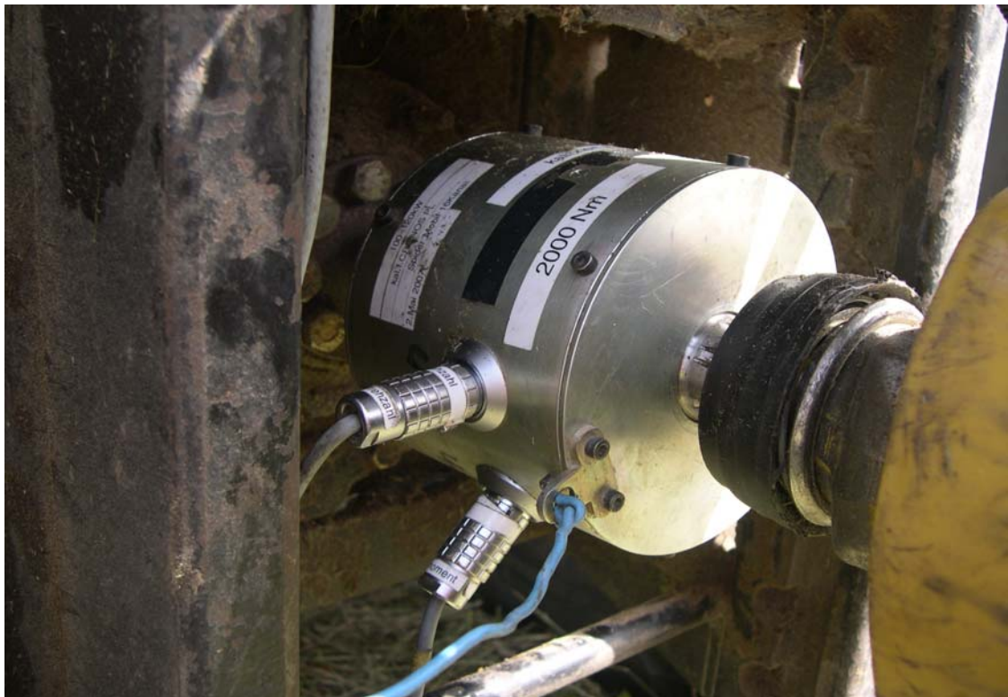
Abbildung 4: Drehmomentaufnehmer zur Ermittlung der Zapfwellenleistung (Eigenphotographie, 2008)
