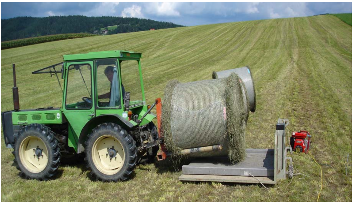
Abbildung 10: Gewichtsmessung eines Ballens (Eigenphotographie, 2008)
