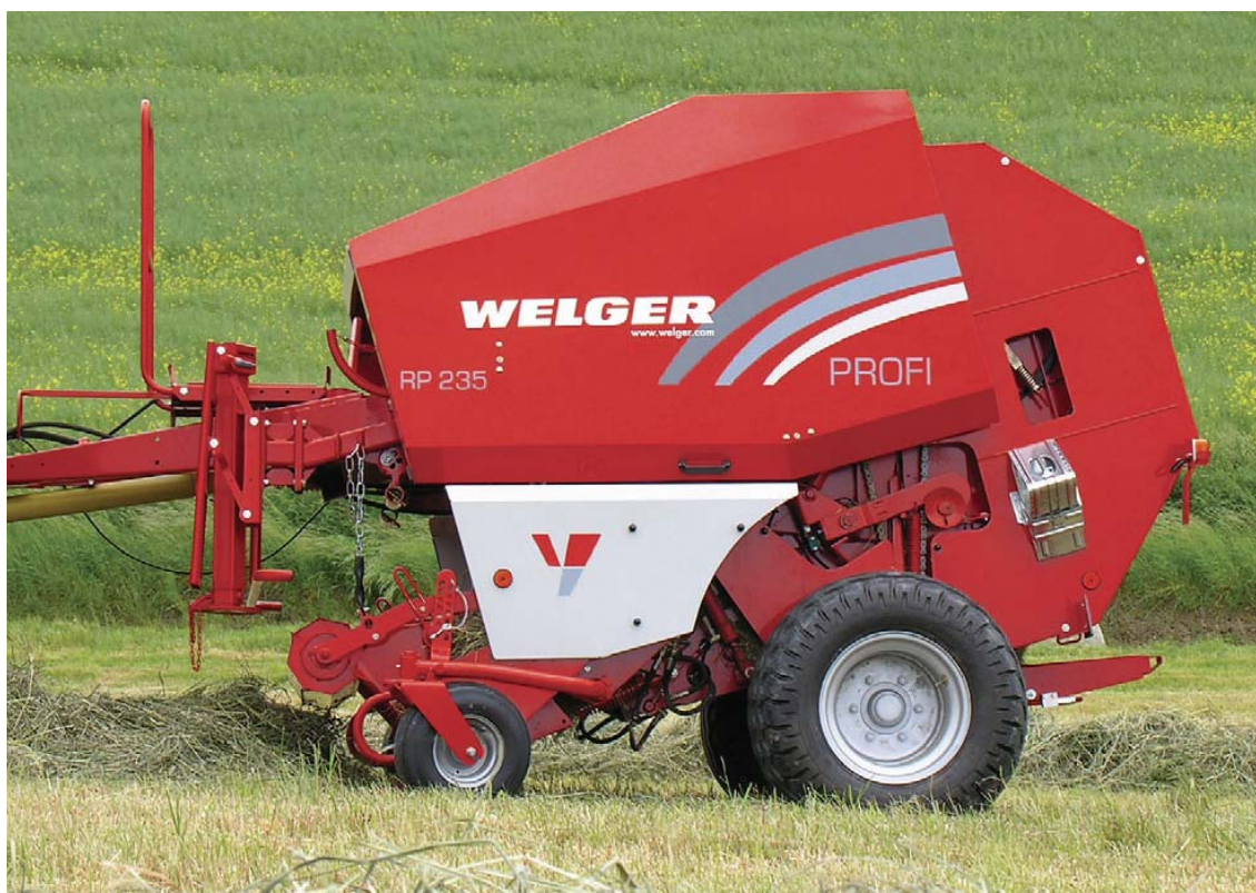
Abbildung 6: Festkammer Rundballenpresse Welger RP 235 (WELGER, 2008)
