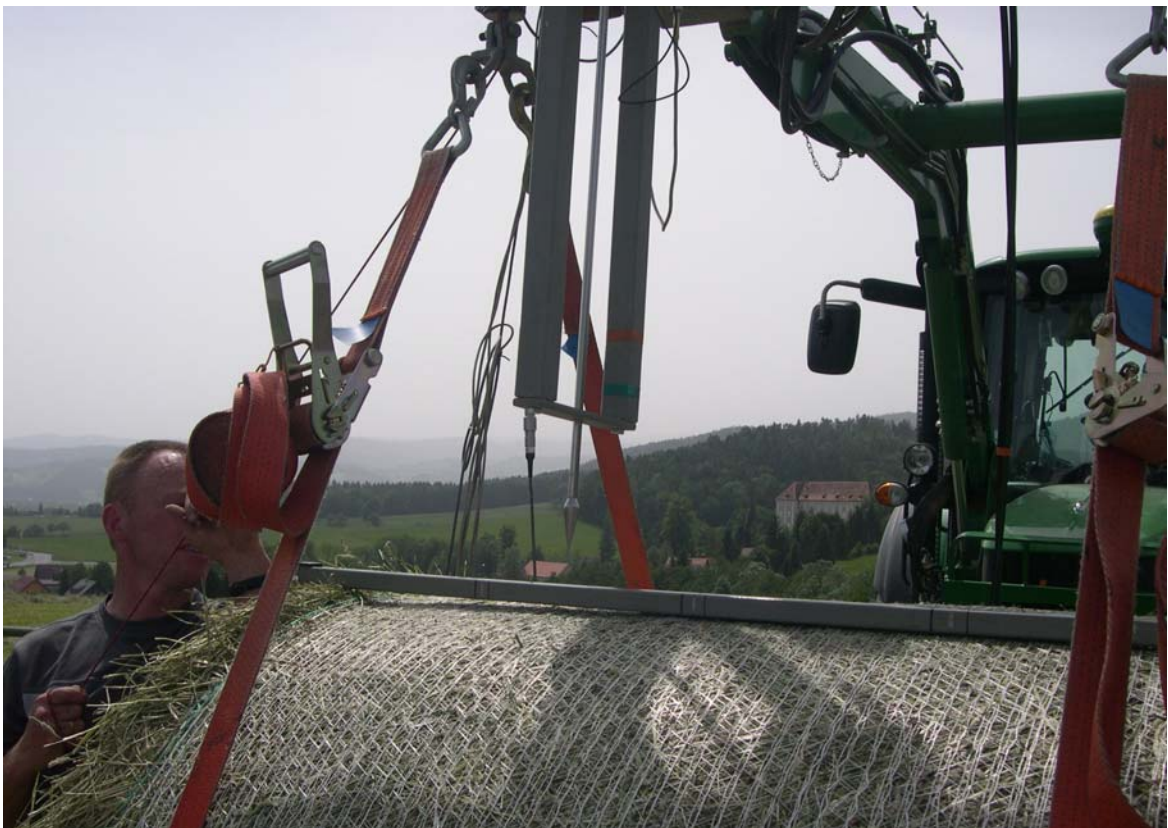
Abbildung 9: Dichtemessung der Rundballen mittels Penetrometer (Eigenphotographie, 2008)
