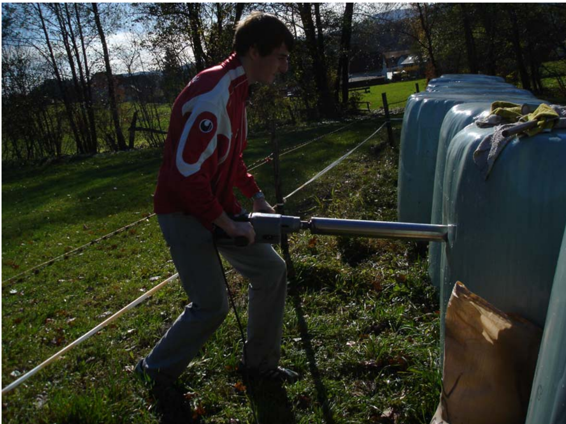
Abbildung 11: Probenahme bei den gärungsfertigen Ballen (Eigenfotographie, 2008)
