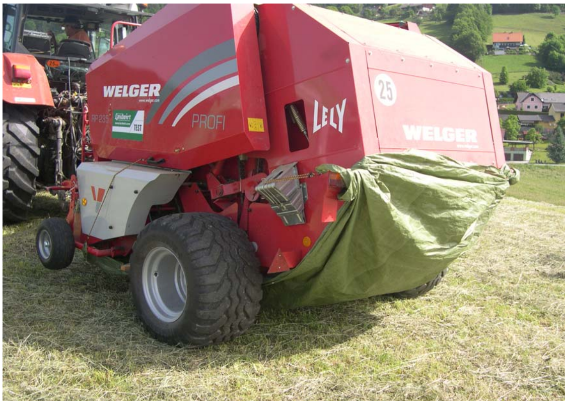
Abbildung 3: Ermittlung der Bröckelverluste mittels „Windeltechnik“ (Eigenfotographie, 2008)
