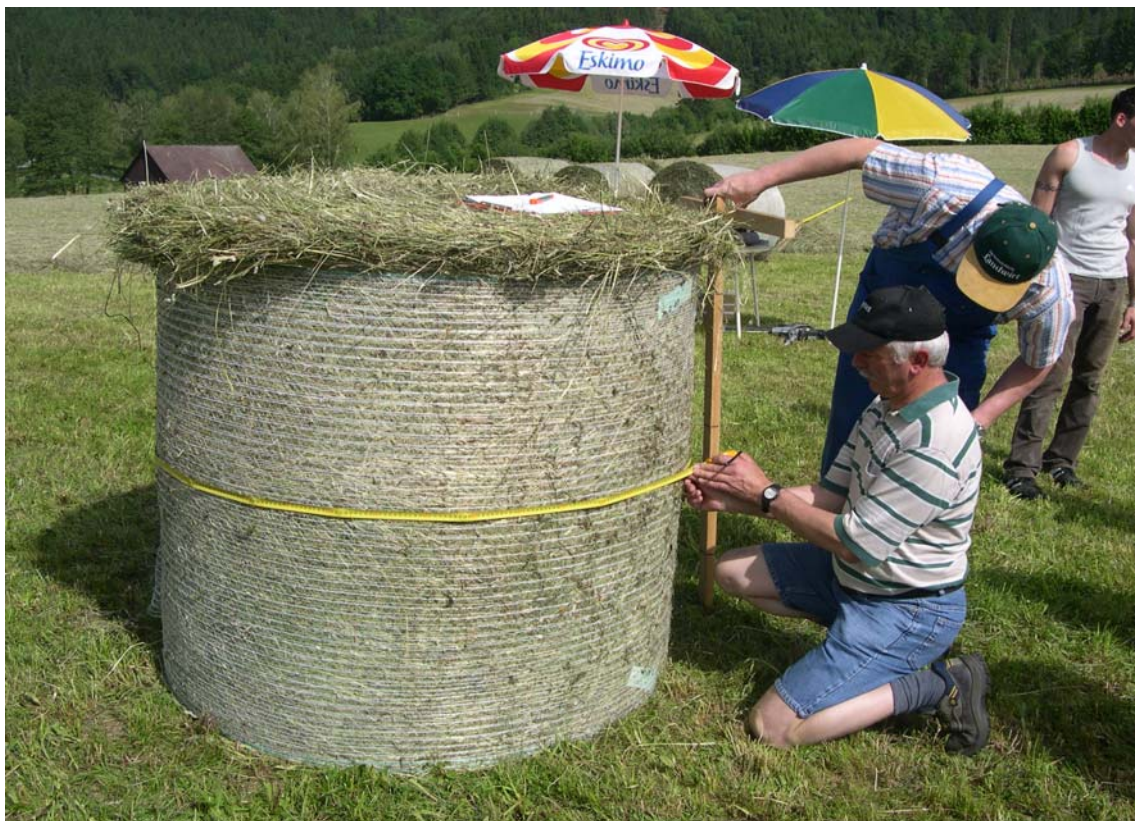
Abbildung 8: Umfangmessung der Rundballen (Eigenfotografie, 2008)
