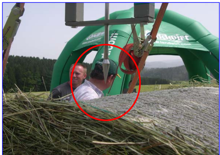
Abbildung 16: Penetrometerspitze zur Ermittlung der Dichte (Eigenfotographie, 2008)
