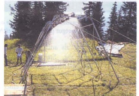
Die Erosionsmessungen auf dem Standort Hochwurzen (1.830 m) zeigten, dass Erosion nur bei Verwendung von Mulchsaaten oder Geotextilien vermieden werden konnte
