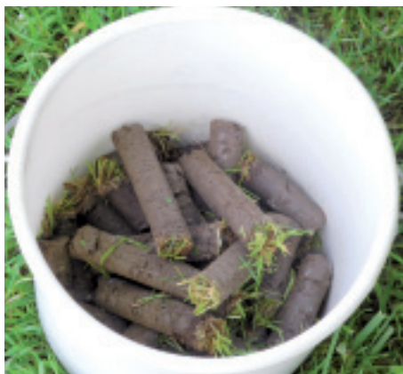
Die Einzelproben sollen in einem sauberen Behältnis zu einer Mischprobe vereinigt werden.
