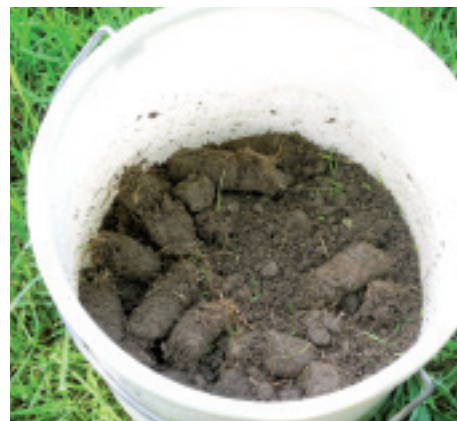
Die Einzelproben sollen in einem sauberen Behältnis zu einer Mischprobe vereinigt werden.
