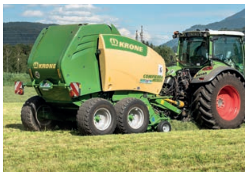
Trotz geringster Ballendichte war auch bei der Krone Comprima die Silage in Ordnung.
