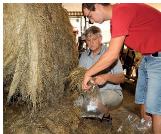
Probennahme für die Schnittlängenanalyse: Beim manuellen Auflösen der Ballen konnten wir keine bedeutenden Unterschiede zwischen den Pressen feststellen.
