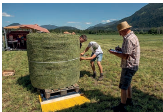
Zur Bestimmung der Ballendichte vermaß und wog die BLT Wieselburg die Ballen exakt.
