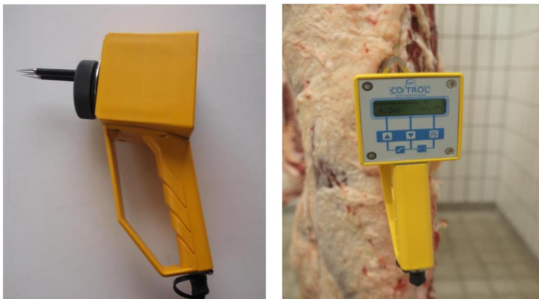
Foto: Leitfähigkeit- und Impedanzmessgerät (Foto: Kitzer)
