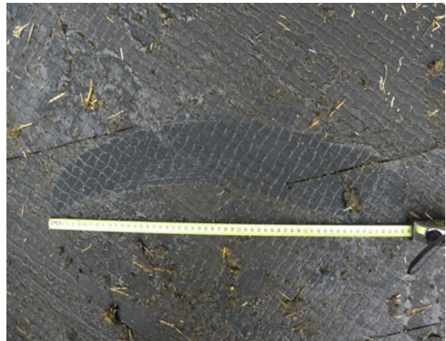
Abbildung 3: Messen einer Rutschlänge – in diesem Beispiel 54 cm
