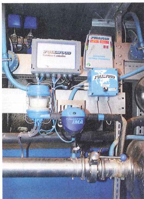
Das IMA-Milchanalysesystem misst mit infrarotem Licht die Milch Inhaltsstoffe bei jeder Melkung für jede Kuh. In Deutschland wird diese Technik bereits für das Herdenmanagement in Großbetrieben genutzt.
