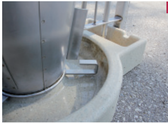
Am Behälter sind vier Flacheisen angeschweißt, die es den Ferkeln erleichtern sollen, den Behälter zu drehen.
