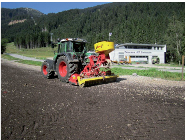
Abbildung 6: oberflächliches Einarbeiten des Komposts mittels Kreiselegge und Einsaat, Schotterrasen Zwieselalm (Gosau, August 2011, Foto Urstöger)
