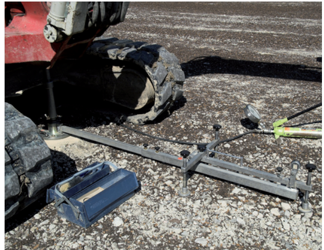
Abbildung 8: statischer Lastplattenversuch zur Überprüfung der Tragfähigkeit, Schotterrasen Zwieselalm (Gosau, August 2011)
