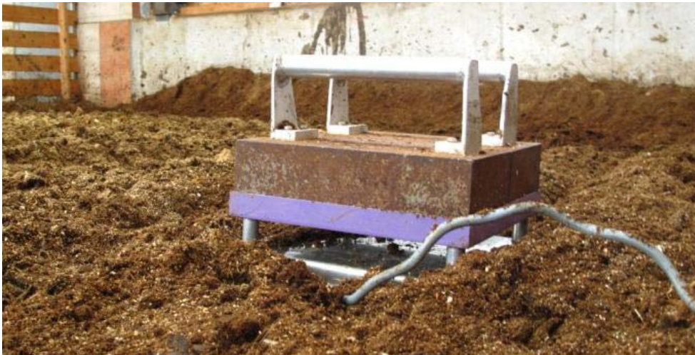
Abbildung 6: Wärmeableitungsmessgerät mit Gewichten (Quelle: GULDIMANN, 2013)
