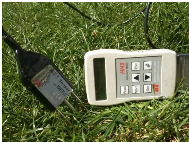
Abbildung 5: Messgerät zur Erfassung der Bodentemperatur und Bodenfeuchte (Quelle: LEITNER, 2016)
