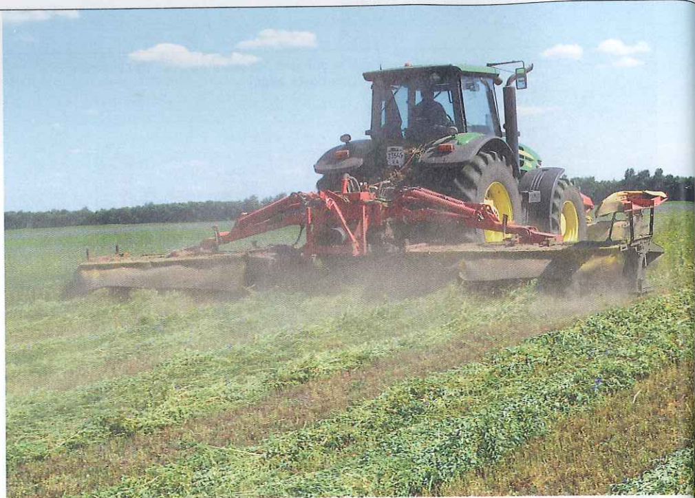
Eine Mahd mit Aufbereiter kann auf stark ausgetrockneten Böden zu Erdaufwirbelung und Futtermverschmutzung führen.
