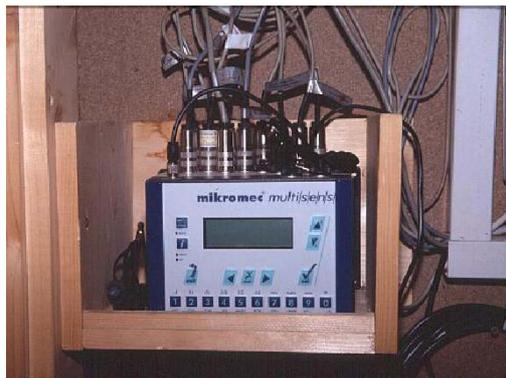
**Abbildung 3: Datenlogger mikromec-multisens**
