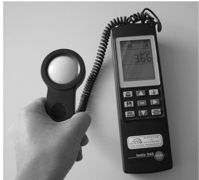
**Abbildung 2: Luxmeter zur Messung der Beleuchtungsstärke**
