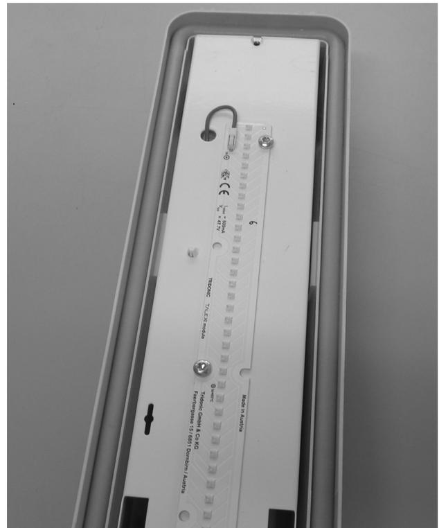
**Abbildung 4: LED Modul Tridonic (Gehäuse Schuch), Quelle: Tridonic**
