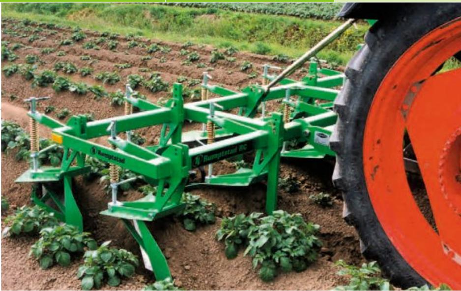
Der Ecoridger von AVR hat Abstreifelemente und „High-Speed-Dammformbleche“ sowie ein Gewichtsübertragungssystem. AVR
