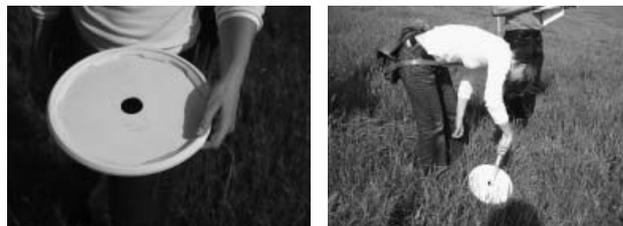
Abbildung 2: Messung der Aufwuchshöhe mit Hilfe der Deckelmethode
