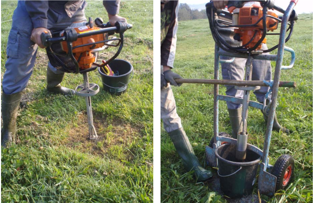
Abbildung 14: Entnahme der Wurzelmasse nach der Bohrkernmethode Fotos: Schmied, 2009
