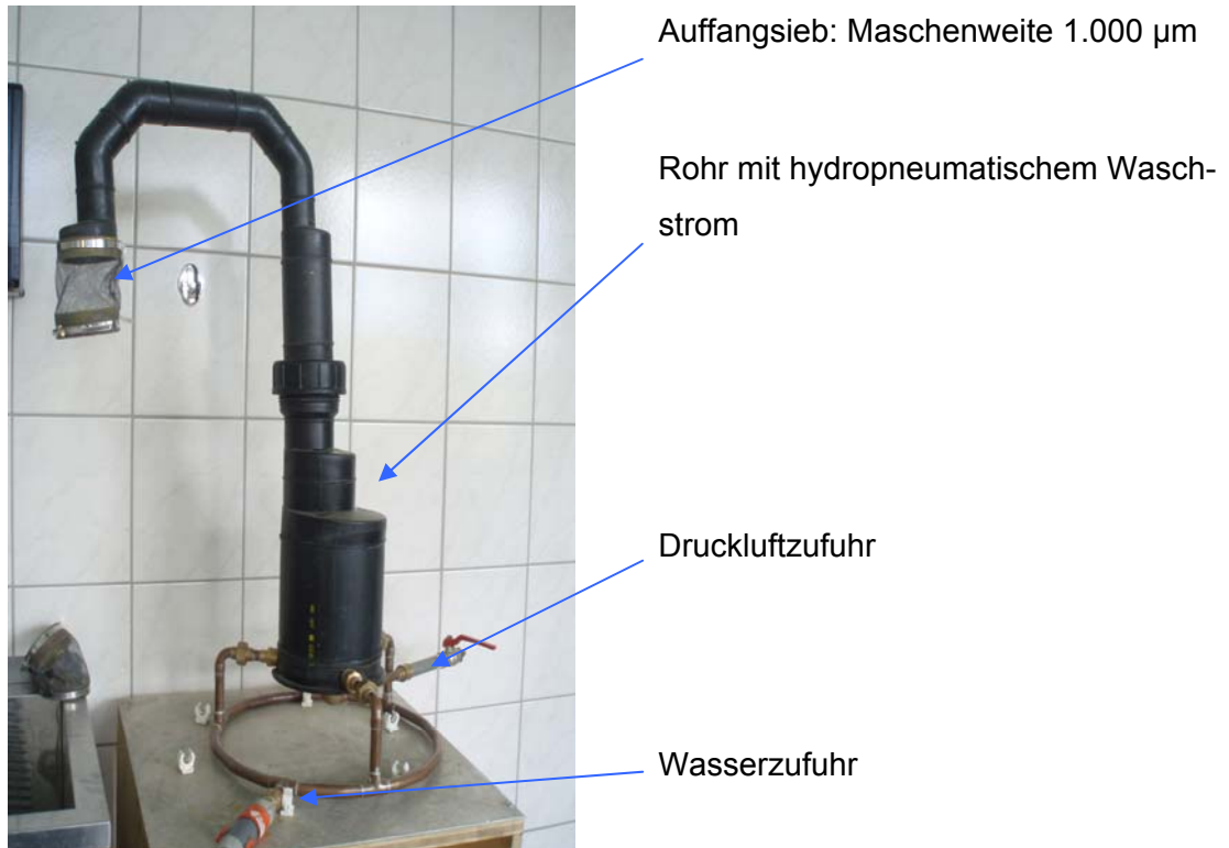
Abbildung 15: Wurzelwaschanlage für die Grobreinigung der Wurzeln Foto: Schmied, 2009
