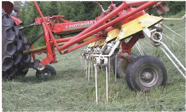
wird, sondern in kleinen Schwaden liegen bleibt. Bei Kreiseltzttwendern mit einem kleinen Kreiseldurchmesser ist die »Schwadbildung« nicht gegeben, das Futter wird gleichmäßig verteilt. Im Zweifelsfall ist immer die sogenannte »Schwadbildung« zu akzeptieren, denn höhere Bröckelverluste sind deutlich schlechter zu bewerten, als eine möglicherweise ungleichmäßigere Abtrocknung des Futters.
