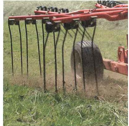
Die Zinken müssen so eingestellt werden, dass sie nicht kratzen – ein bis drei Zentimeter vom festen Boden entfernt.
