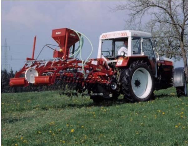
Bildserie: Kombigeräte eignen sich sehr gut für Pflege- und Grünlanderneuerung in einem einzigen Arbeitsgang (Bilder: K. Buchgraber)
