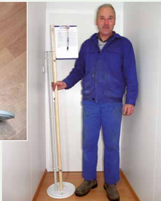
Ein selbstgebautes Aufwuchsmessgerät mit Klemmmappe. Am unteren Ende des Holzstieles befindet sich eine Blechscheibe. Lusterhaken dienen der Führung des Leerrohres
