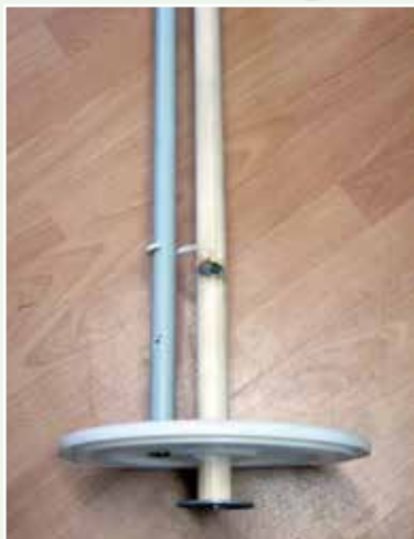
Ein selbstgebautes Aufwuchsmessgerät mit Klemmmappe. Am unteren Ende des Holzstieles befindet sich eine Blechscheibe. Lusterhaken dienen der Führung des Leerrohres
