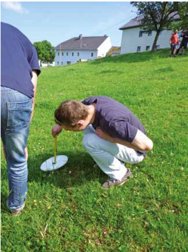
Messen der Aufwuchshöhe mit der Deckelmethode
