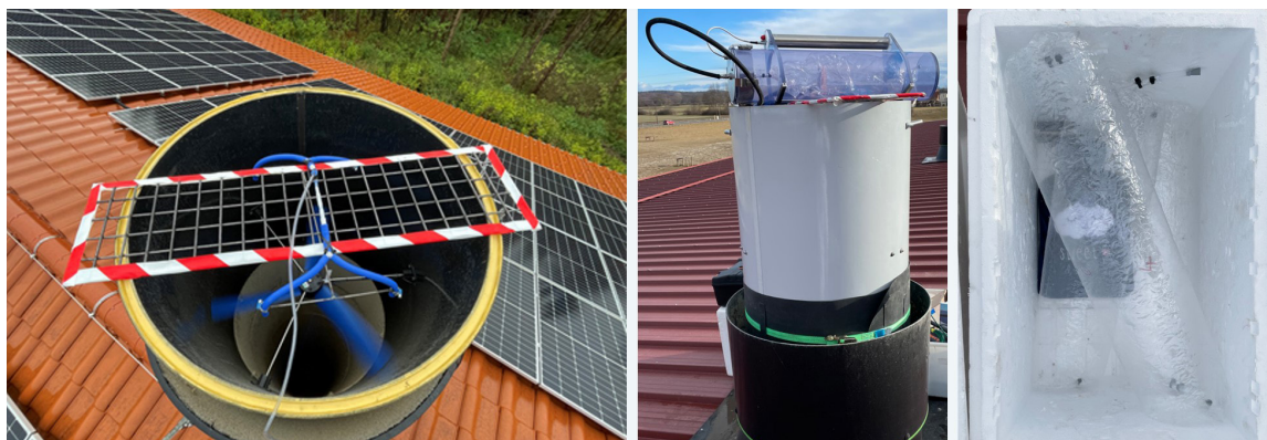
Abb. 1: Geflügelbetrieb: Messkamin mit Vorrichtung zur Geruchsprobenziehung und Messventilator (links), Messkamin und Probensammler CSD30 (Mitte) und gefüllte Nalophan-Säcke in Isolierbox (rechts) (© M. Kropsch)
