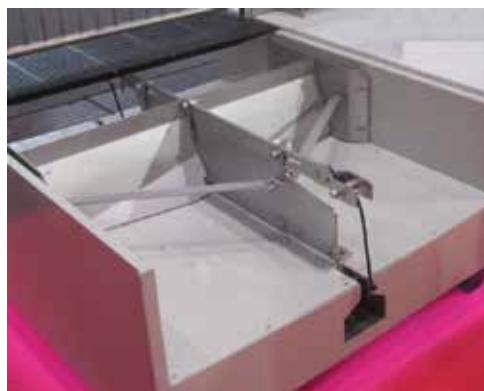
Abbildung 7: Schieberentmistungstechnik im Auslaufbereich (Quelle: Schauer Agrotec GmbH)
