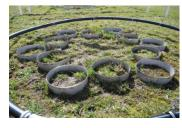
Drei sensorgesteuerte (Niederschlag und Wind), seitlich offene Regendächer für je 4 Versuchsparzellen mit Ableitung des Niederschlags in den Oberflächenwasserkanal
