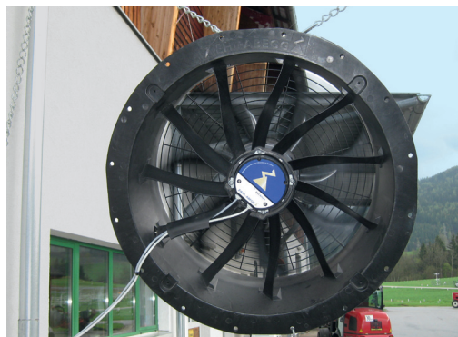
Ein Axialventilator hat einen sehr niedrigen Energiebedarf.
