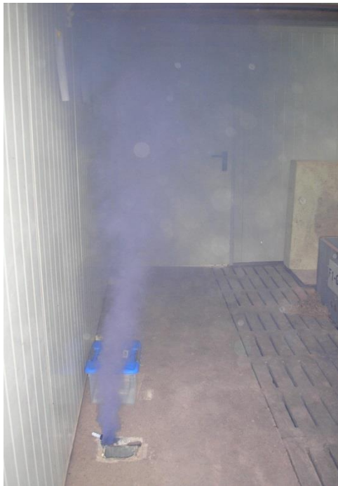
Abbildung 67: Durch den Einsatz von Rauchpatronen werden Luftströmungen sichtbar – links: Weg der Zuluft im Versuchsabteil Gießhübl / rechts: Absaugung über den im Abteil installierten Ventilator
