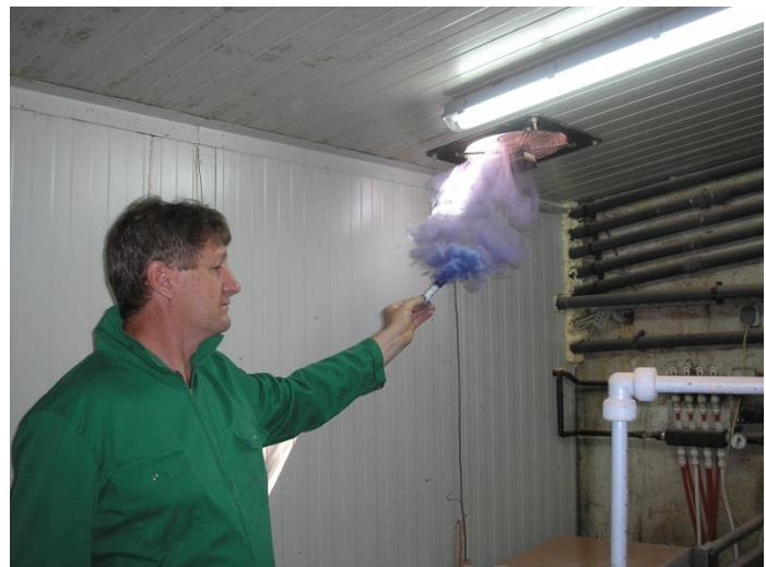
Abbildung 67: Durch den Einsatz von Rauchpatronen werden Luftströmungen sichtbar – links: Weg der Zuluft im Versuchsabteil Gießhübl / rechts: Absaugung über den im Abteil installierten Ventilator
