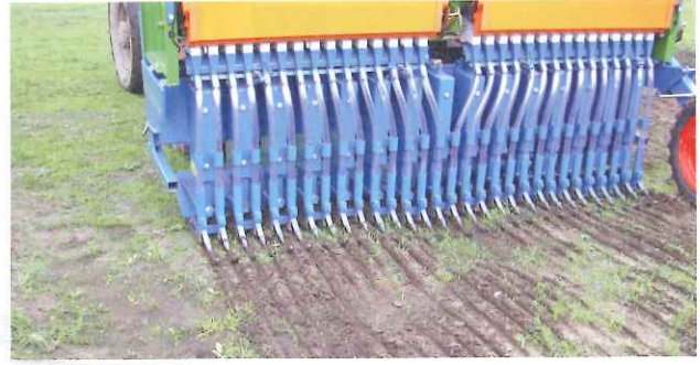
Foto 4: Schlitzdrillgeräte brauchen für den sinnvollen Einsatz einen stark lückigen Bestand. Die Keimlinge überdauern aufgrund des guten Bodenschlusses Trockenzeiten besser im Vergleich zu den anderen Verfahren.
