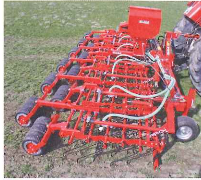
Foto 2: Der klassische Grünlandstriegel mit 7 (8) mm starke Zinken ist für die periodische Übersaat auf Flächen mit lockererdigen Böden und geringem Unkrautdruck geeignet.
