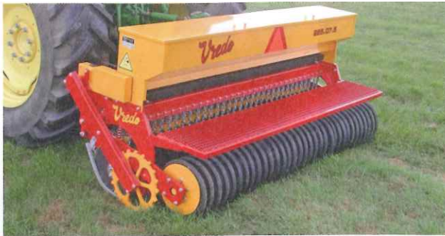
Foto 4: Schlitzdrillgeräte brauchen für den sinnvollen Einsatz einen stark lückigen Bestand. Die Keimlinge überdauern aufgrund des guten Bodenschlusses Trockenzeiten besser im Vergleich zu den anderen Verfahren.
