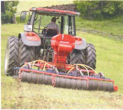
Foto 2: Der klassische Grünlandstriegel mit 7 (8) mm starke Zinken ist für die periodische Übersaat auf Flächen mit lockererdigen Böden und geringem Unkrautdruck geeignet.
