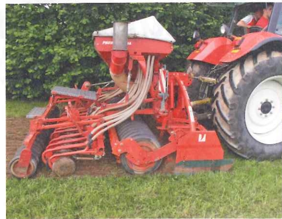
Foto 5: Kreiselgrubber mit Packerringwalzen, pneumatischem Säsystem, Scheibensärscharen und Gummiwalze ermöglichen eine rasche Bestandsveränderung, Vorsicht bei Wurzelunkräutern!
