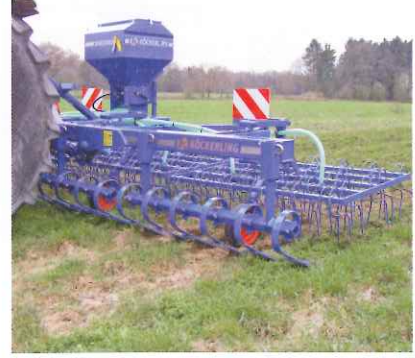
Foto 2: Der klassische Grünlandstriegel mit 7 (8) mm starke Zinken ist für die periodische Übersaat auf Flächen mit lockererdigen Böden und geringem Unkrautdruck geeignet.
