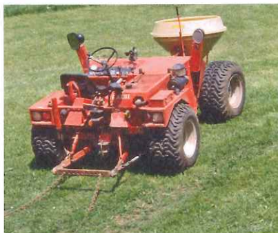
Foto 1: Baustahlgitter in Kombination mit einem Pendeldüngerstreuer und Wiesenschlepple sind die günstigste Übersaatmethode, brauchen aber einen lückigen Bestand.
