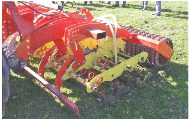
Foto 3: Wiesenstriegel mit stärkeren Zinken sind auch zum Durchlüften verfilzter Bestände und zum Ausriegeln der Gemeinen Rispe geeignet. Fast alle Hersteller bieten mittlerweile Striegel auch mit 10- oder 12-mm-Zinken an.
