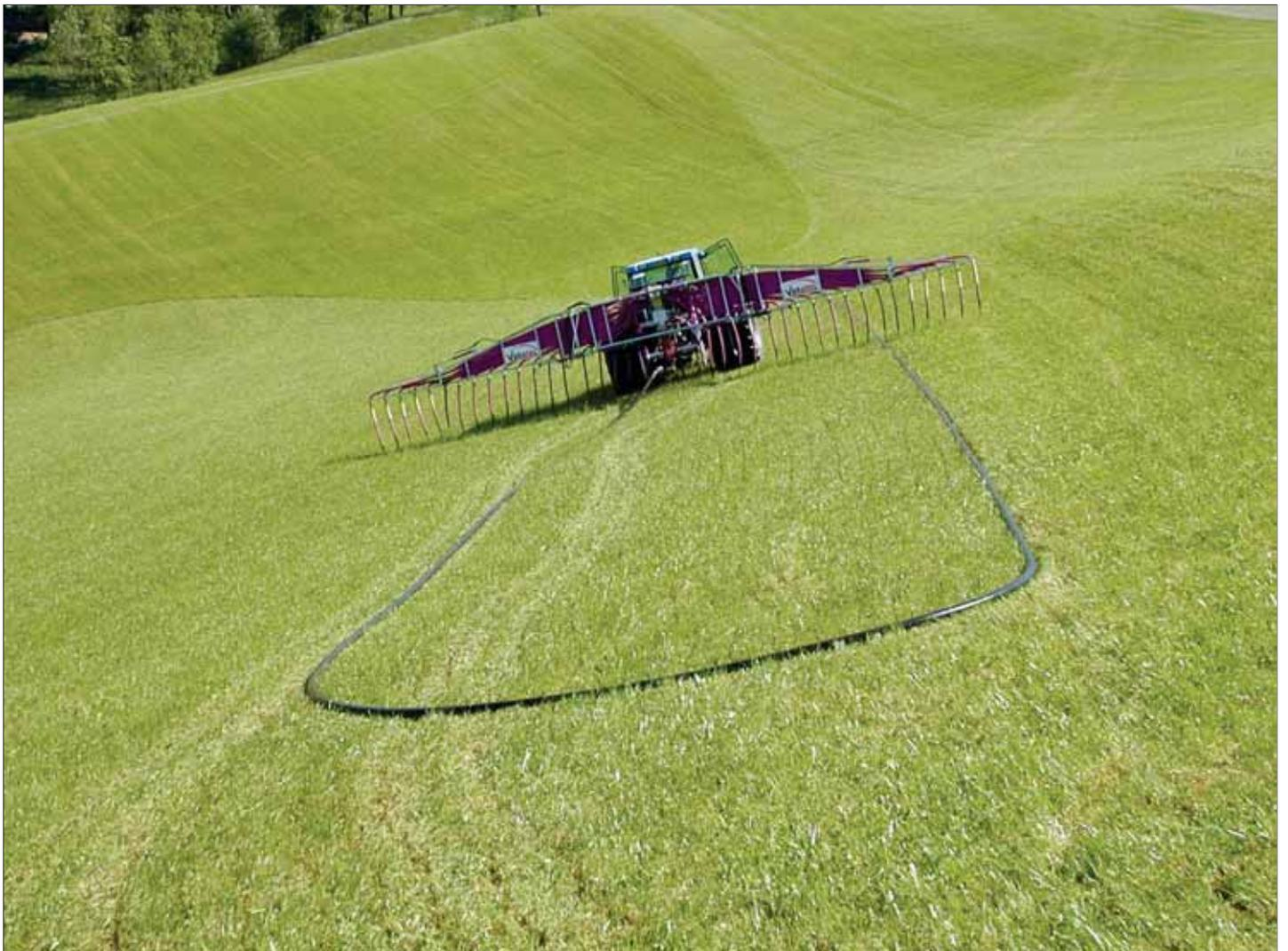
**Schleppschlauchverteiler am Hang!?**
