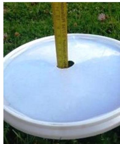
*Abbildung 19: Messung der Aufwuchshöhe mittels Deckelmethode (eigene Quelle)*
