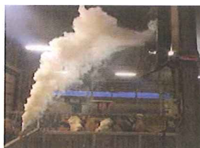
Rauch macht durch Ventilatoren erzeugte Luftströme sichtbar.
