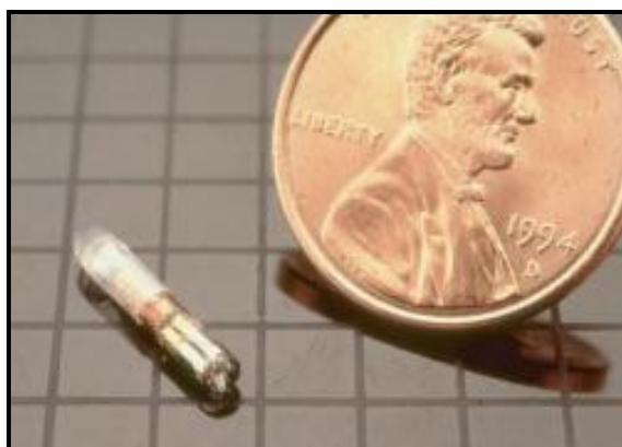
Abbildung 7: Größenvergleich des verwendeten LifeChip ® mit Bio-Thermo ™ Technologie ( www.destronfearing.com )
