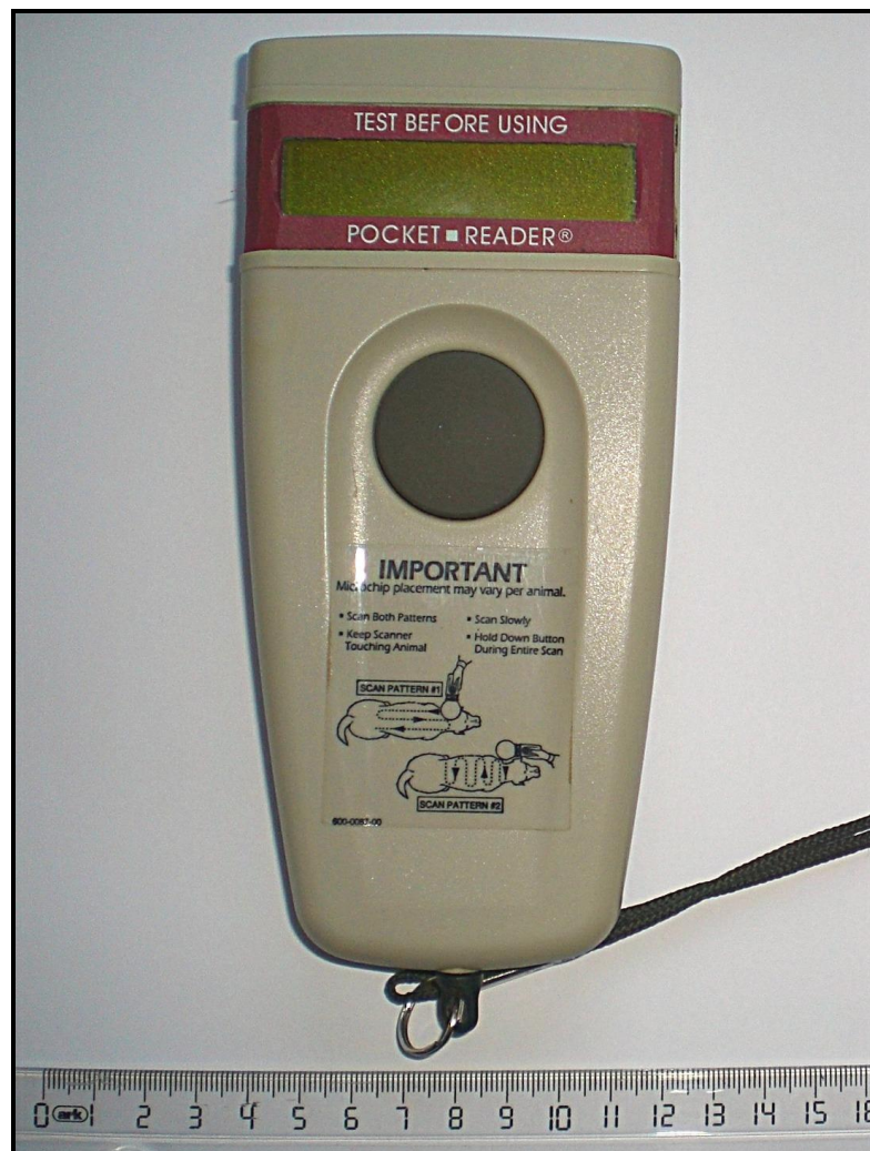
Abbildung 9: Mit dem Destron Fearing™ Pocket Reader® wurde die Temperatur seitlich am Hals abgelesen
