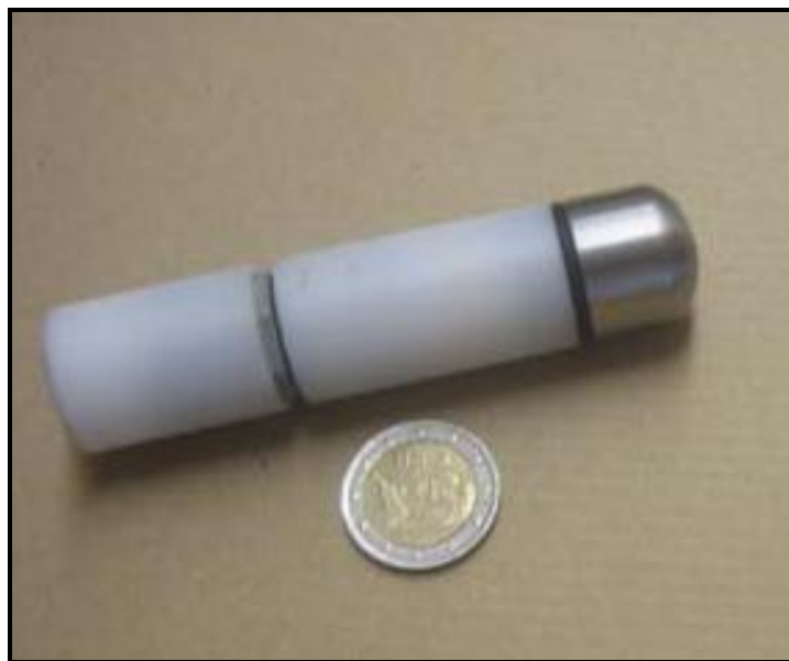
Abbildung 10: Intraruminale Temperaturmeseinheit mit einer Länge von 180mm, einem Ø von 36mm und einem Gewicht von 208g (Gasteiner, 2009)
