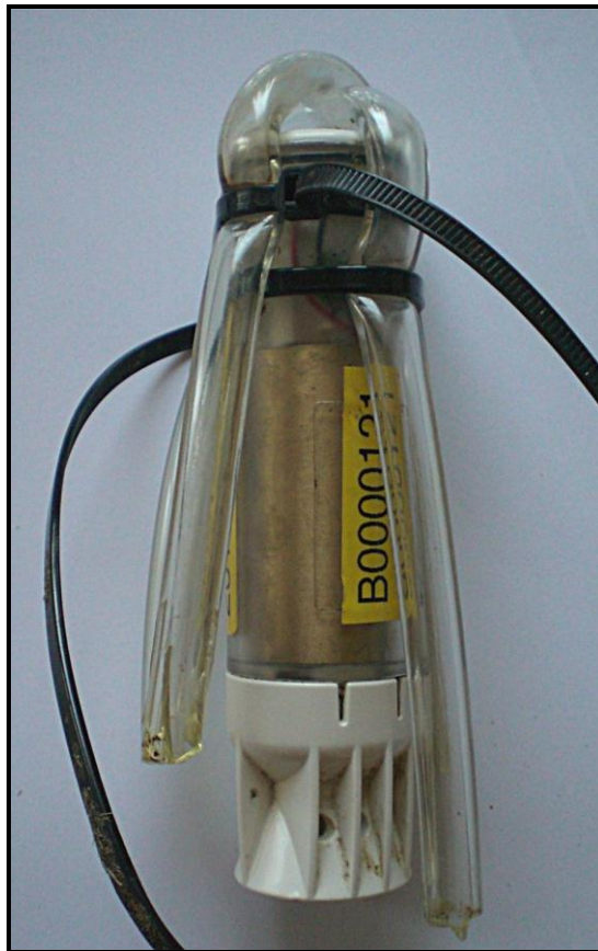
Abbildung 4: Angebrachte Gummischläuche zur Erhöhung des Widerstandes
