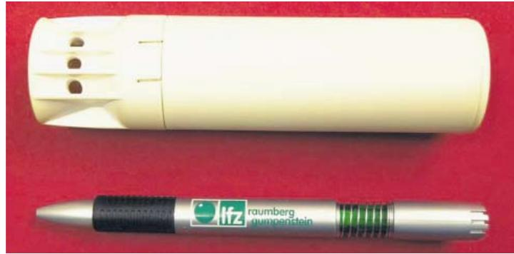
So sieht die Messeinheit zur Messung des pH-Wertes im Pansen aus.
